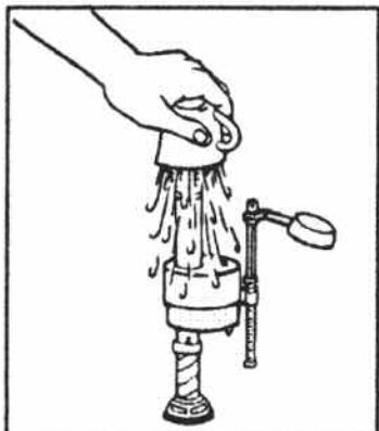
**SCHÉMA 2 :** Placez un contenant sur le ROBINET pour éviter les éclaboussures, coupez l'alimentation en eau et rétablissez-la à quelques reprises. Coupez l'alimentation en eau.
