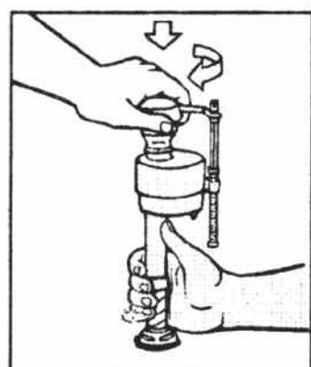
**SCHÉMA 3:** Replacez le CAPUCHON et tournez de 1/8 tour dans le sens horaire. ASSUREZ-VOUS QUE LE CAPUCHON EST VERROUILLÉ. LE ROBINET POURRAIT NE PAS S'OUVRIR SI LE CAPUCHON N'EST PAS DANS LA POSITION VERROUILLÉE.
