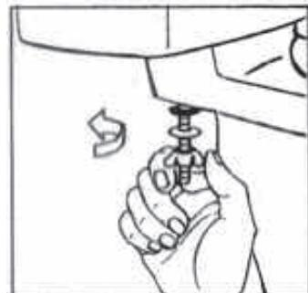
a. Deslice la empaquetadura de gomaespuma nueva (el lado pequeño hacia abajo) sobre el extremo roscado de la válvula para descarga de inodoro.
