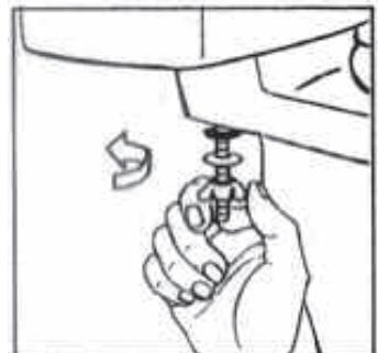
a. Glissez la nouvelle garniture d'étanchéité en caoutchouc spongieux (grand diamètre en premier) sur l'extrémité filetée du robinet de chasse.
