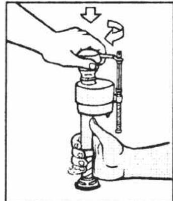
**DIAGRAMA 3:** Vuelva a colocar la PARTE SUPERIOR colocando orejetas y girando 1/8 de vuelta en dirección contraria a las manecillas del reloj. ASEGÚRESE DE QUE LA PUNTA QUEDA EN LA POSICIÓN DE BLOQUEO. ES POSIBLE QUE LA VÁLVULA NO SE ACTIVE SI LA PARTE SUPERIOR NO SE ENCUENTRA COMPLETAMENTE EN LA POSICIÓN DE BLOQUEO.
